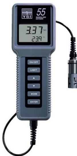
**Figura 4.** Oxímetro comercial para la determinación del oxígeno disuelto en acuarios.
