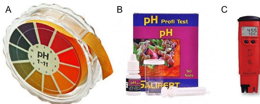
**Figura 3.** Principales equipos usados para la determinación del pH del agua en acuarios. A) Papel tornasol o papel pH. B) Kit comercial colorimétrico. C) Medidor de pH/temperatura.
