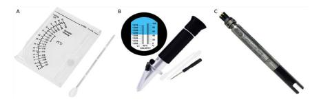
**Figura 2.** Principales equipos usados para la determinación de la salinidad del agua en acuarios. A) Hidrómetro. B) refractómetro. C) Sensor de salinidad/temperatura.
