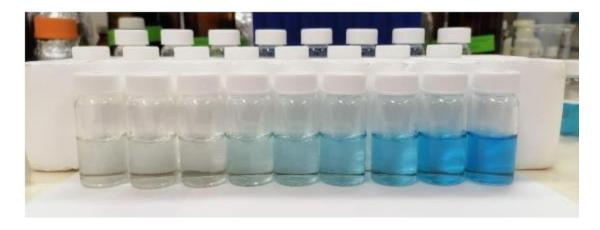
**Figura 19.** Curva de fosfato. En la imagen se puede observar el gradiente de color azul relacionado con la concentración (de izquierda a derecha).
